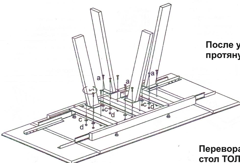
**После установки всех винтов, протянуть их ключом**
